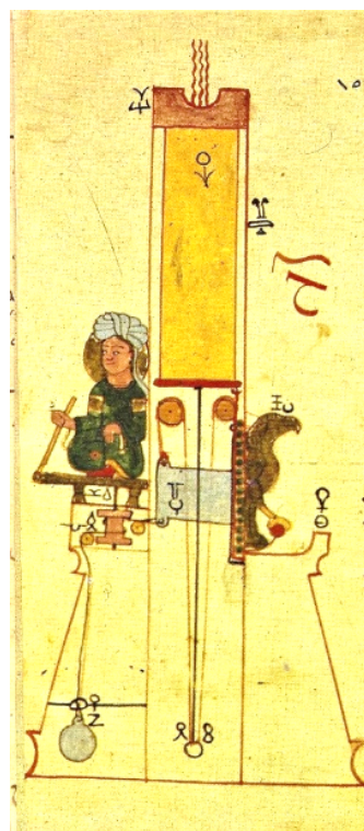
شکل ۱. ساعت شمعی، کتاب فی معرفه الحیل الهندسیه، بدیع الزمان جزری، ۶۰۲ ق، کتابخانه کاخ توپقاپی (شماره MS 3472, Ahmet III, گ ۱۵۷ ر).
