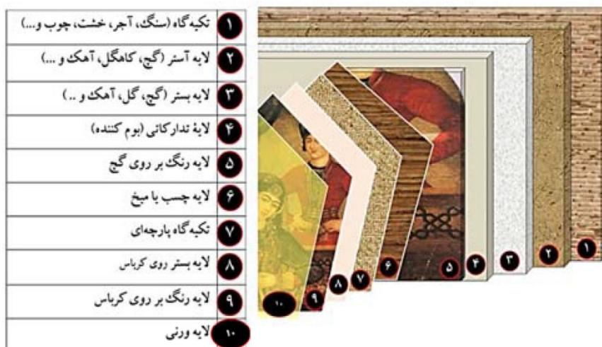
شکل ۱. لایه‌های تشکیل‌دهنده‌ی دیوارنگاره‌های بوم‌پارچه (حمزوی، ۱۴۰۱، ۴۸).
